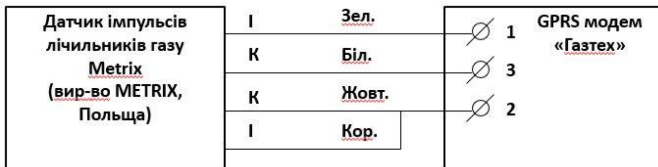
Рисунок 3 - Схема підключення датчика імпульсів лічильників САМГАЗ до GPRS модему Газтех
