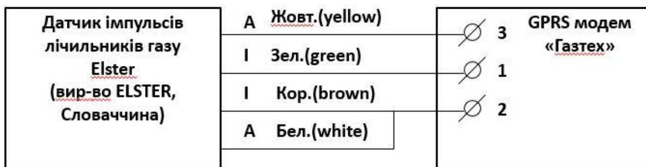
Рисунок 6 - Схема підключення датчика імпульсів лічильників Elster до GPRS модему Газтех
