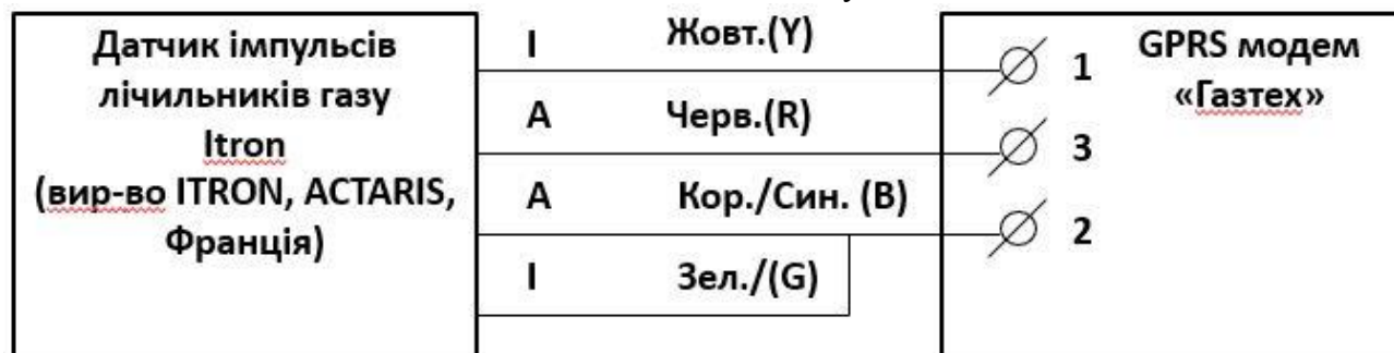
Рисунок 4 - Схема підключення датчика імпульсів лічильників Metrix до GPRS модему Газтех
