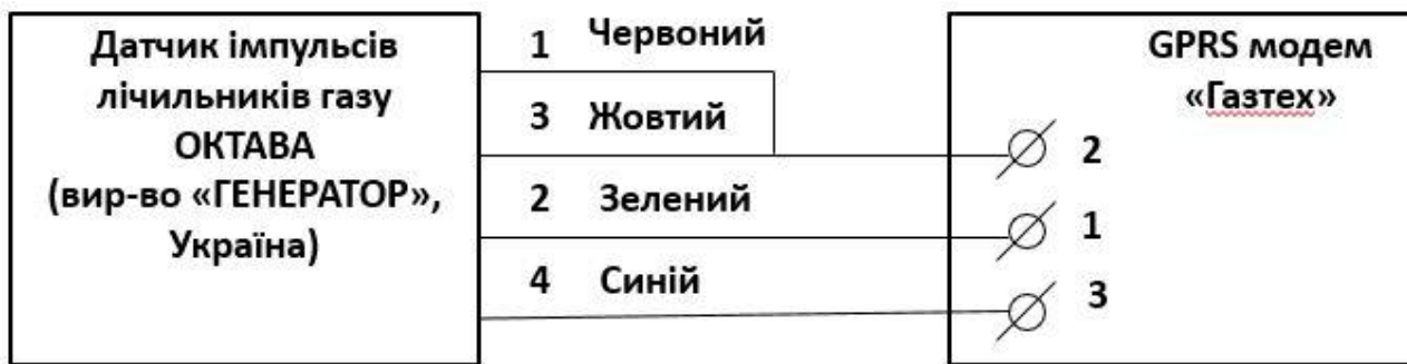
Рисунок 7 - Схема підключення датчика імпульсів лічильників ОКТАВА до GPRS модему Газтех
